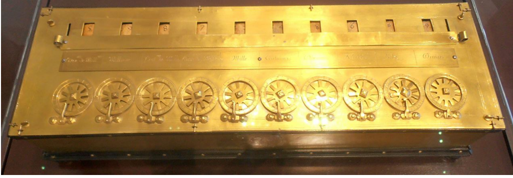
Şekil 1.1: Blaise Pascal'ın 1642'de yaptığı mekanik hesap makinesi (Pascaline)
